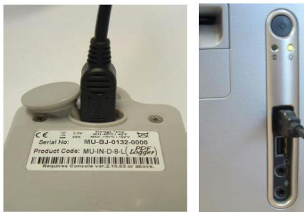
Figur 1: Bruk USB-ledningen for å koble temperaturloggeren til en PC.
